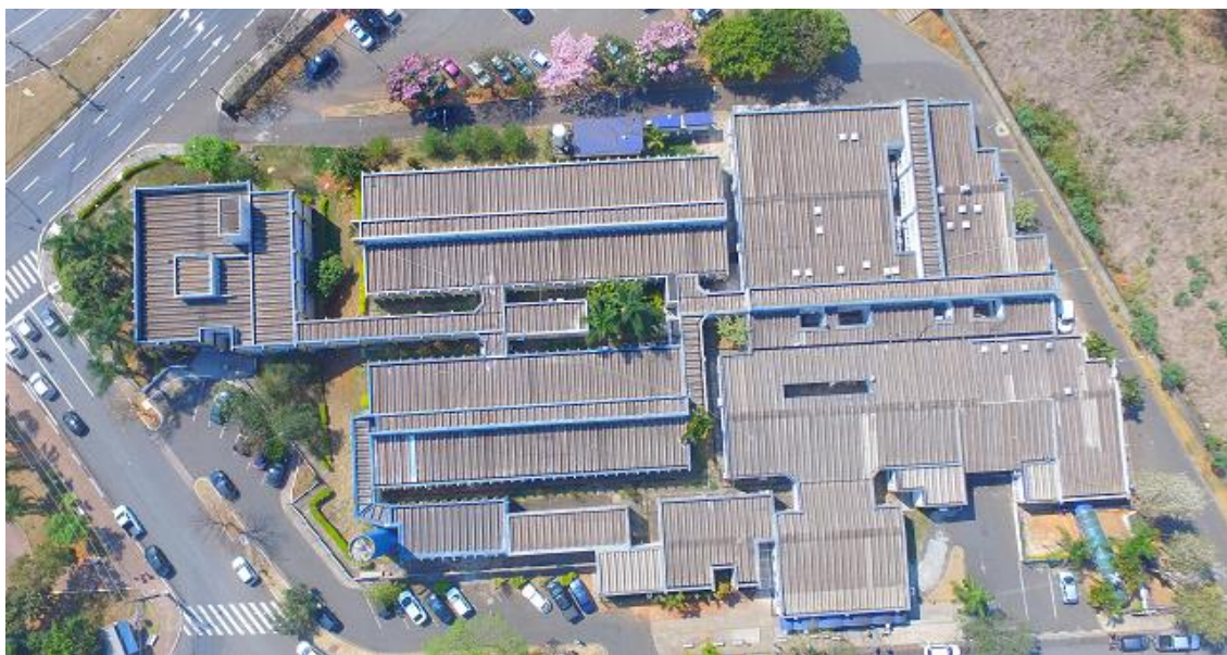
Foto 19: Cobertura atual. A cobertura atual manteve o diagrama da cobertura existente, com acréscimo nas áreas de pátios, que foram integradas ao edifício.
