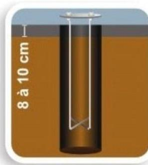
2. Coloque o chumbador. Segure-o um pouco acima do buraco e preencha-o com concreto.
