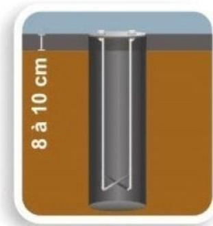
3. Assente a flange do chumbador no nível rente à calçada. A calçada deverá ter de 8 à 10 cm de espessura de concreto.
