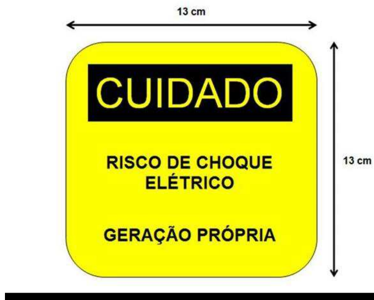
Figura 4 – Placa de Advertência
