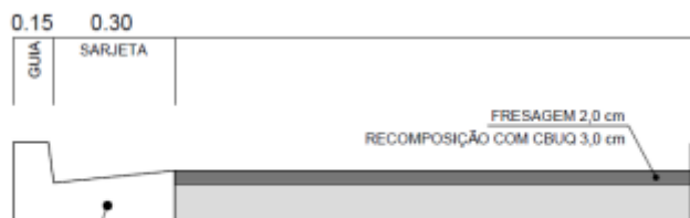
Figura 1: Seção tipo I – Reabilitação Funcional
